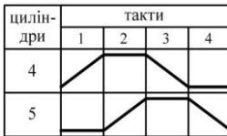
Рисунок 5.27 – Циклограма роботи пневмопривода
