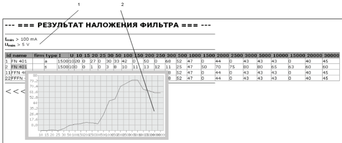
Рис. 6. Страница с результатами выбора фильтров по заданным параметрам: 1 – критерии отбра фильтров: ток 100 мА, напряжения 5В; 2 – область с результатами отбора фильтров
