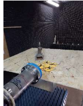
Рис.1. Загальний вигляд випромінюючого хвилевода з рупорною антеною та об'єктом впливу в безеховій камері
