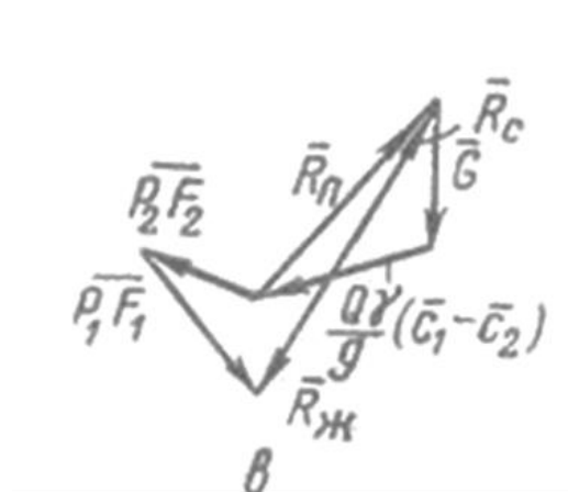
Рисунок. 1.33 - Багатокутник сил в криволінійному каналі турбіни
