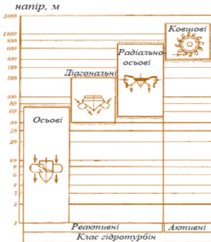
Рисунок. 1.13. Застосування типів гідротурбін по напору
