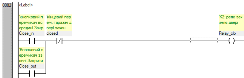
Рисунок 2.35 – Текст LDR-програми, що відповідає безпечному функціонуванню гаражних дверей
