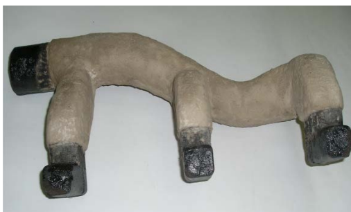
Рис. 2. Литейный стержень с многофункциональным покрытием.
