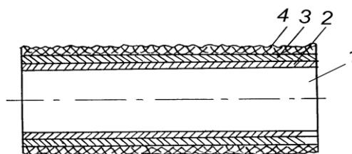
Рис.1. Схема литейного стержня с многослойным теплоизолирующим покрытием:
