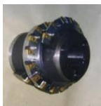
Рис. 1. Евольвентна черв'ячна фреза з роздільною схемою формоутворення m = 20 мм
