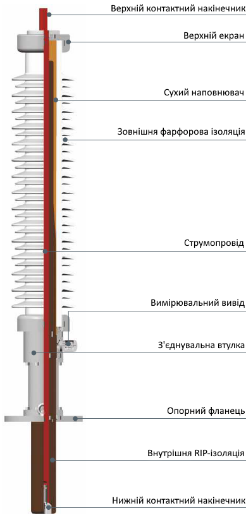
Рисунок 1.28 - Ввод «елегаз –повітря» з RIP-ізоляцією для КРПЕ
