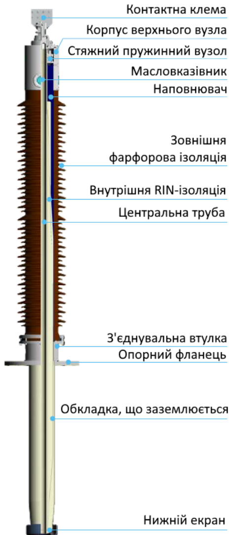
Рисунок 1.20 – Ввод з фарфоровою зовнішньою ізоляцією
