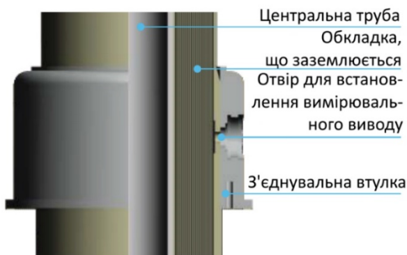
Рисунок 1.22 – Внутрішня RIN-ізоляція
