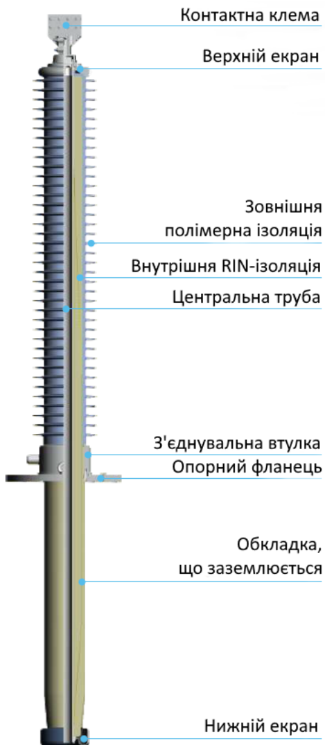
Рисунок 1.21 – Ввод з полімерною зовнішньою ізоляцією
