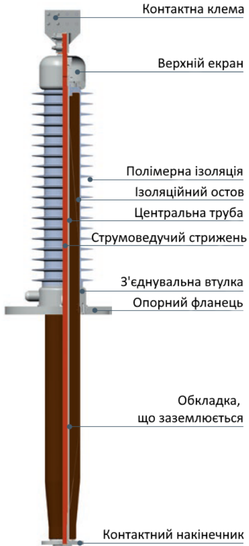
Рисунок 1.2 – Ввод з полімерною зовнішньою ізоляцією
