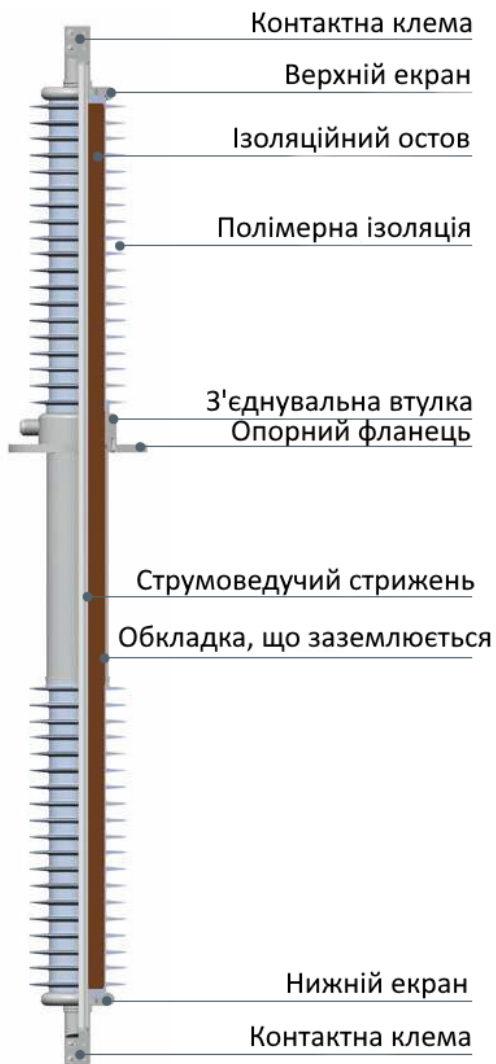
Рисунок 1.16 – Ввод з полімерною зовнішньою ізоляцією
