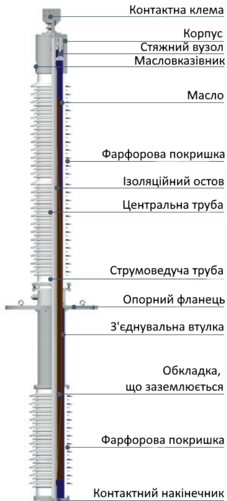
Рисунок 1.1 – Ввод з фарфоровою зовнішньою ізоляцією
