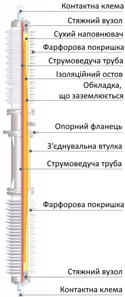
Рисунок 1.15 – Ввод з фарфоровою зовнішньою ізоляцією
