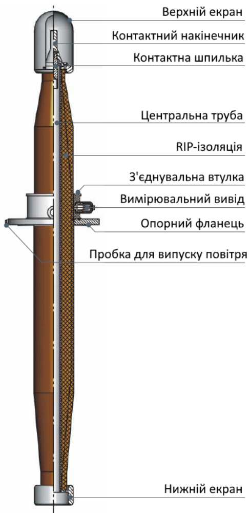
Рисунок 1.26 – Ввод «масло» – «масло» для кабельного підключення трансформаторів
