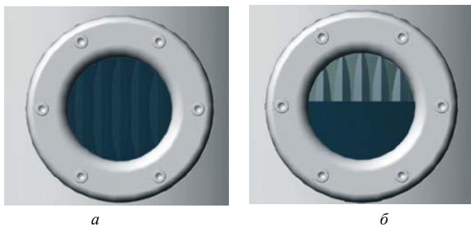
Рисунок 1.8 – Нормальний (а) та знижений (б) рівні рідкого наповнювача
