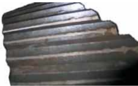
Рис. 5.32. Відшаровування металу ( a ) і заїдання у вигляді задирок ( б )
