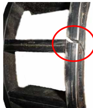
Рис. 10.23. Тріщини в кутах вікон сепаратора ( a ) і зруйноване кільце сепаратора ( б )
