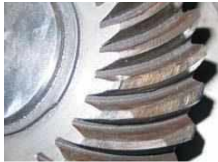
Рис. 5.32. Відшаровування металу ( a ) і заїдання у вигляді задирок ( б )
