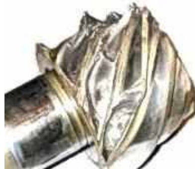
Рис. 5.33. Спрацювання прямозубого колеса ( a ) і руйнування косих зубців шестірни ( б )
