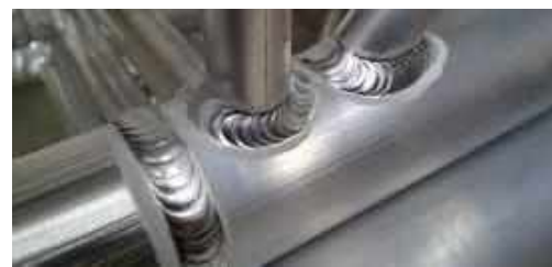
а б Рис. 15.1. Зварні з'єднання коробчастих ( а ) і трубних ( б ) деталей
