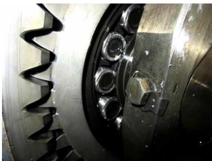
Рис. 5.33. Спрацювання прямозубого колеса ( a ) і руйнування косих зубців шестірни ( б )
