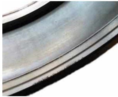
Рис. 10.21. Знос поверхонь центрування: a – кільце сепаратора; б – бортів зовнішнього кільця підшипника
