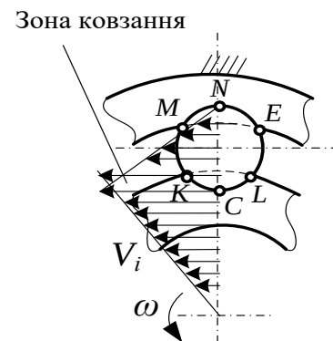
Рис. 10.15. Схема утворення зони ковзання
