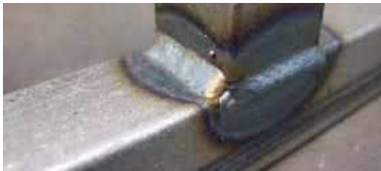
а б Рис. 15.1. Зварні з'єднання коробчастих ( а ) і трубних ( б ) деталей
