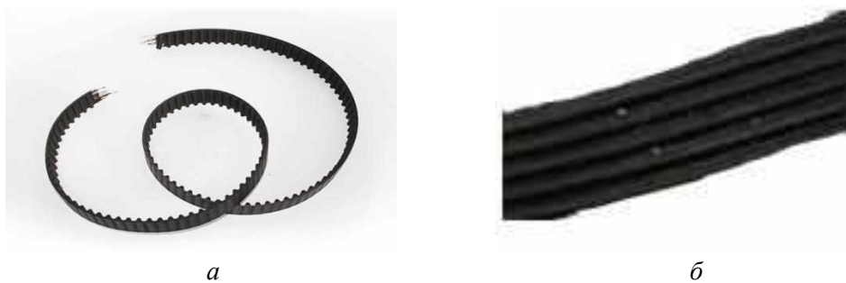
Рис. 3.12. Зруйнований зубчастий (а) і пошкоджений полікліновий (б) паси
