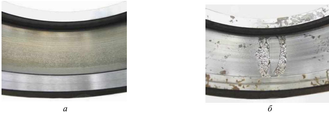
Рис. 10.19. Контактно-утомне викришування: а – луцення; б – раковини
