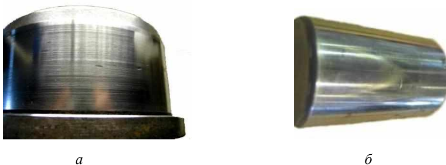
Рис. 10.20. Залишкові деформації (вм'ятини): а – на кільці; б – на ролику
