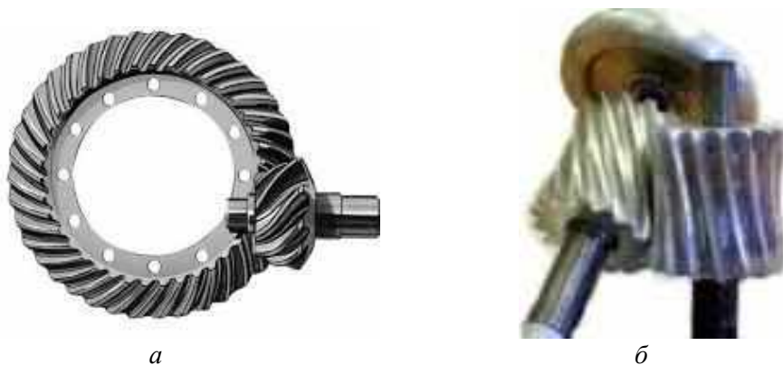
Рис. 6.2. Види гіперболоїдних передач: а – гіпоїдна; б – гвинтова
