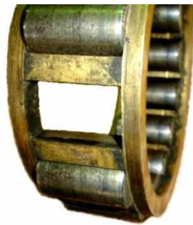
Рис. 10.21. Знос поверхонь центрування: a – кільце сепаратора; б – бортів зовнішнього кільця підшипника
