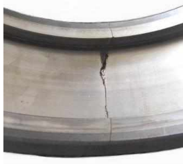
Рис. 10.22. Руйнування зовнішнього кільця ( a ) і ролика ( б )
