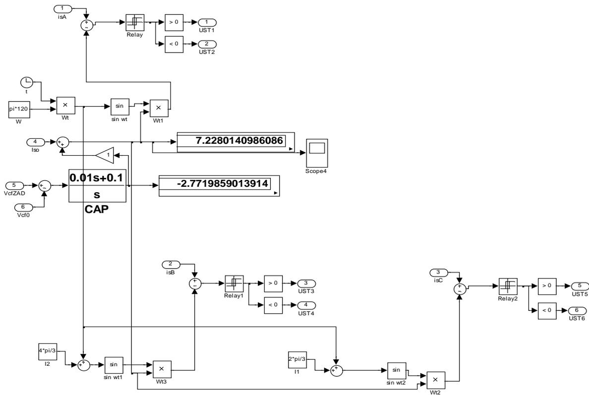
Рис.4 Модель системы управления силовым активным фильтром
