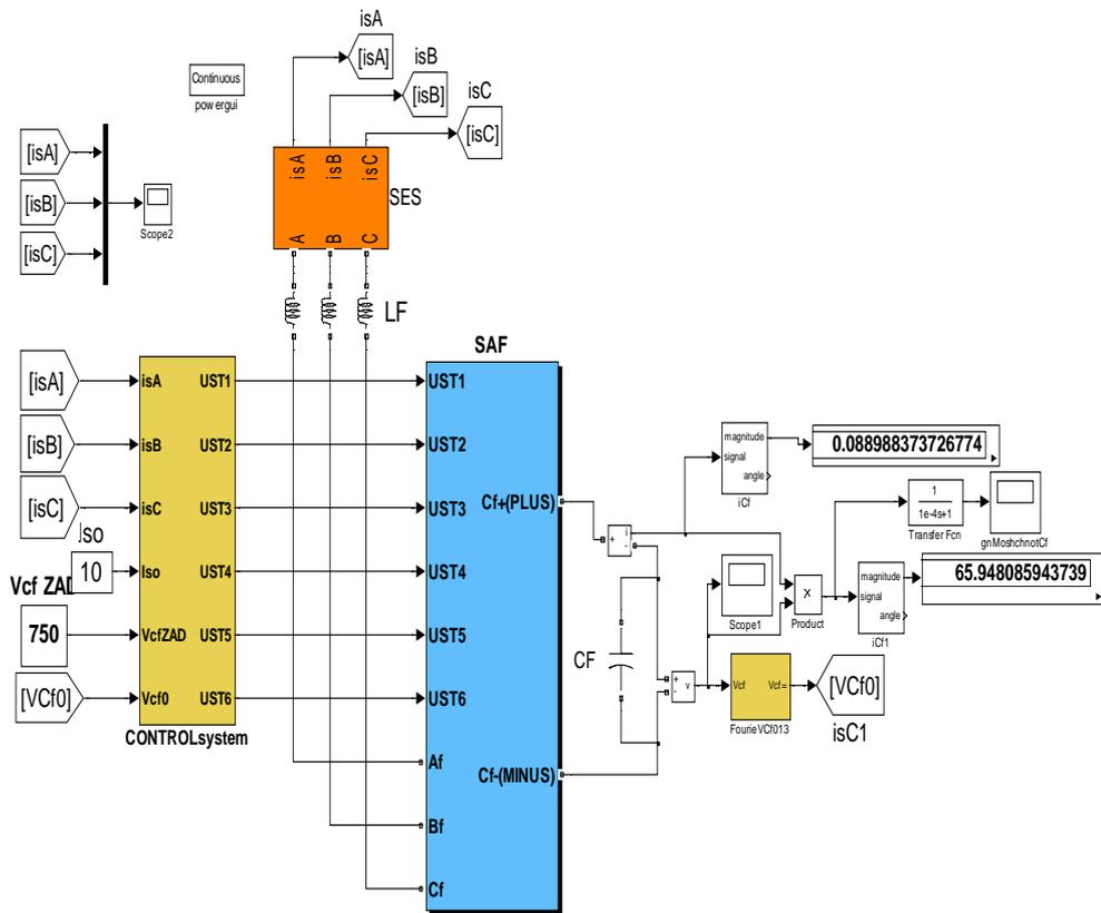
Рис.1. Структурная схема исследуемой системы электроснабжения асинхронного двигателя с силовым активным фильтром
