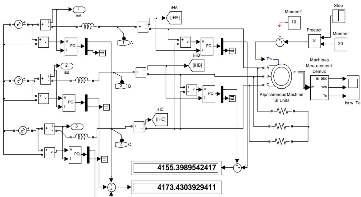
Рис 2. Система собственно электроснабжения асинхронного двигателя
