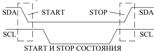
Такая ситуация определяет START-условие. Переход "0->1" на линии SDA, если при этом линия SCL находится в состоянии "1", определяет STOP-условие.
