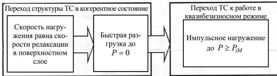
Рисунок 3 – Программное нагружение для моделирования квазибездозного трения:  $P$  – давление в зоне контакта зубчатой пары
