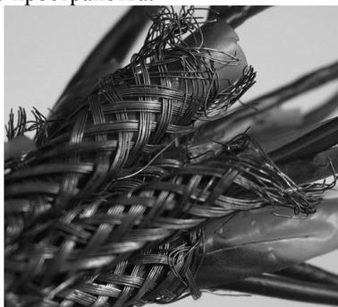
Рис. 1 - Экраны пар контрольного кабеля КПЭТИ 7×2×0,7.
