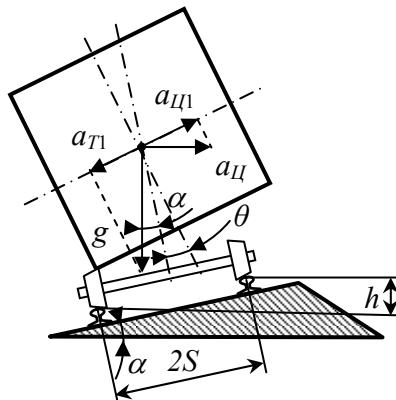
Рис. 1 – Движение экипажа с наклоном кузова:
