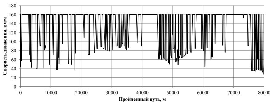
Рис. 2 – Предельные ограничения скорости по участкам при отсутствии наклона кузова
