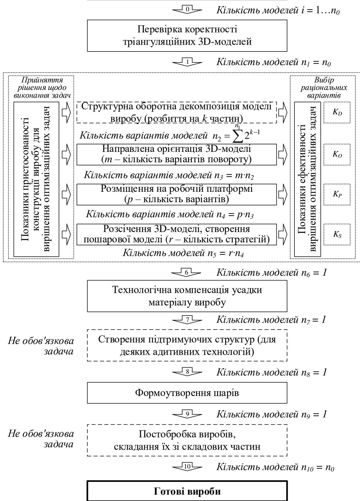
Рисунок 4.2 – Запропонована схема комплексного вирішення задач на етапі планування технологічної підготовки АМ-процесів
