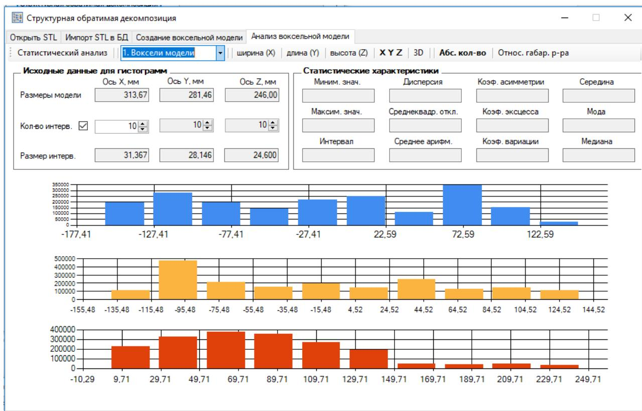
Рисунок 6.40 – Форма з результатами аналізу другого варіанту розподілу матеріалу виробів (рис. 6.38) у робочому просторі окремо за осями  $X$ ,  $Y$ ,  $Z$
