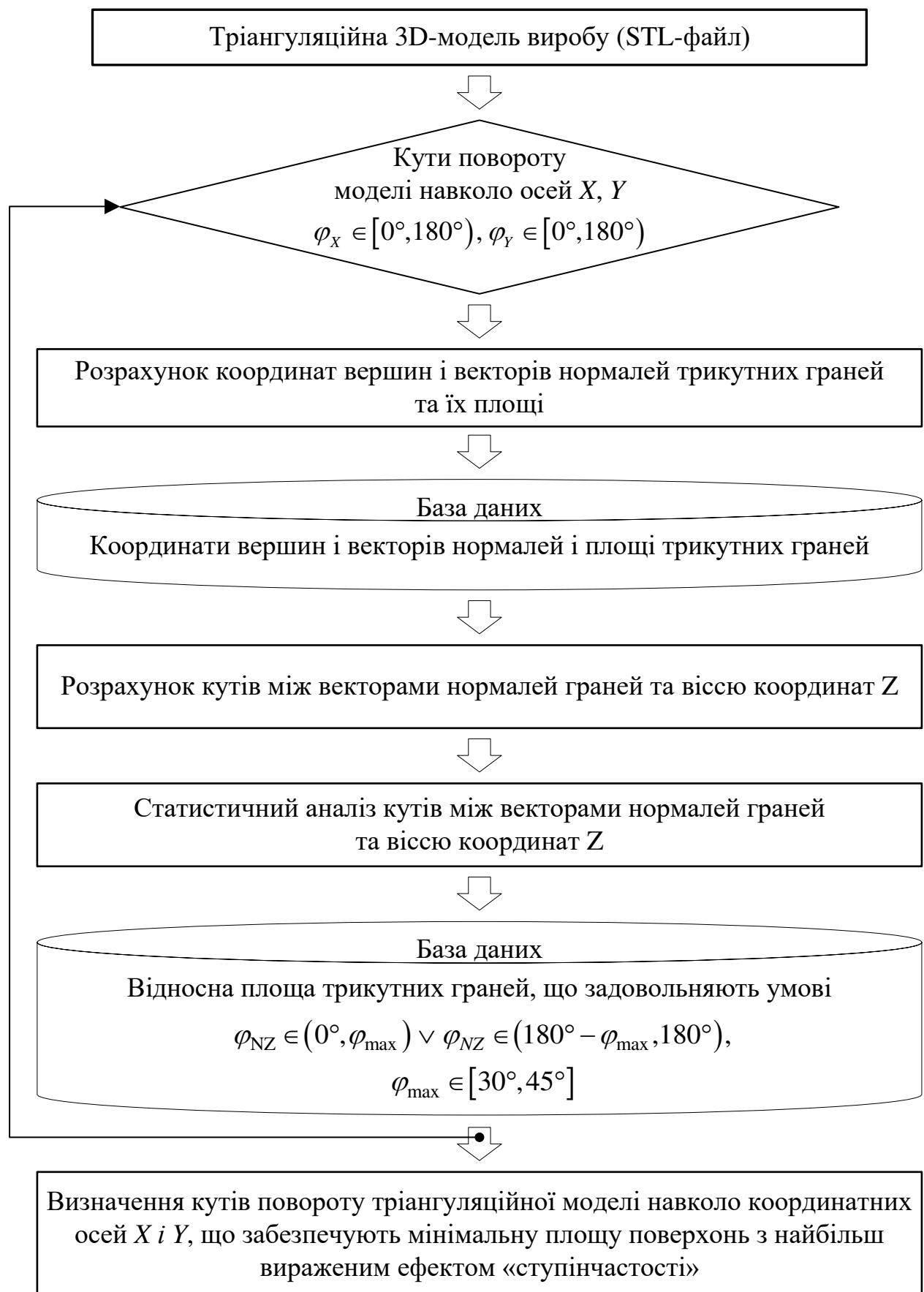
Рисунок 5.15 - Алгоритм визначення кутів повороту 3D-моделі виробу для його раціональної орієнтації у робочому просторі АМ- установки
