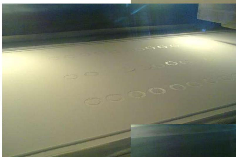
Процес вирівнювання шару порошку
