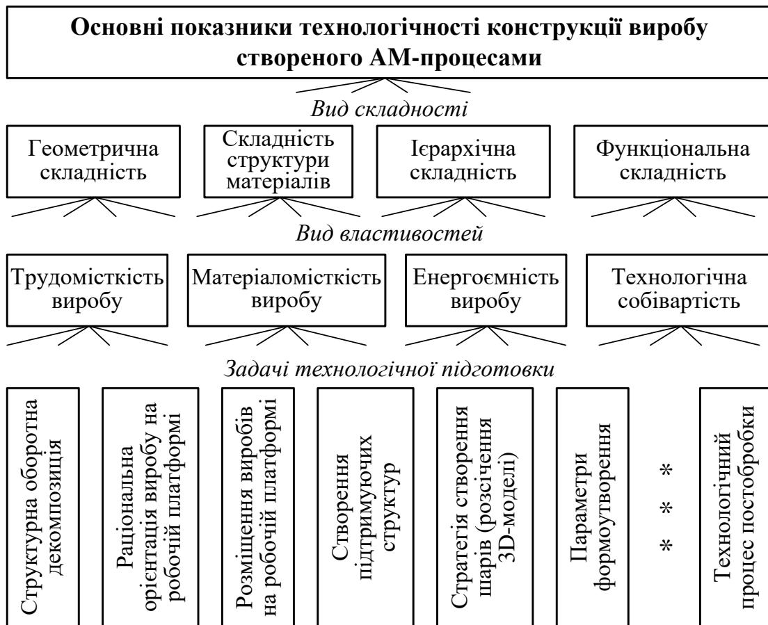
Рисунок 3.3 – Класифікація показників технологічності конструкції виробу
