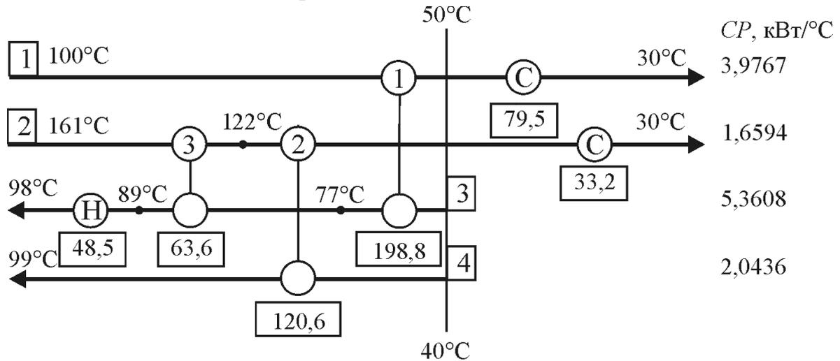
Рис. 1. Сеточная диаграмма теплообменников, установленных после модернизации
