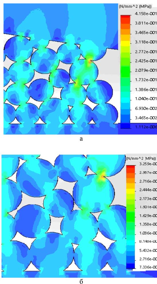
Рис. 1 – Напряжения в элементах загрузки: а – после удара шаром; б – в середине слоя под давлением верхних элементов загрузки.
