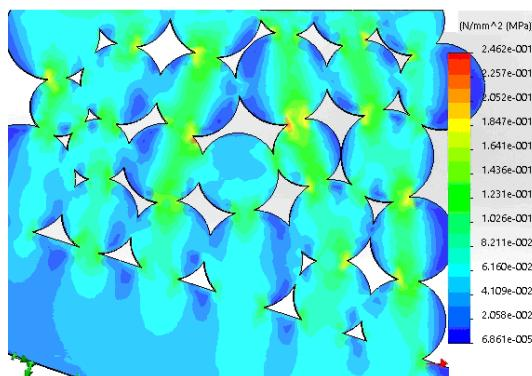
Рис. 2 – Напруження в елементах загрузки в області предела прочності матеріала.
