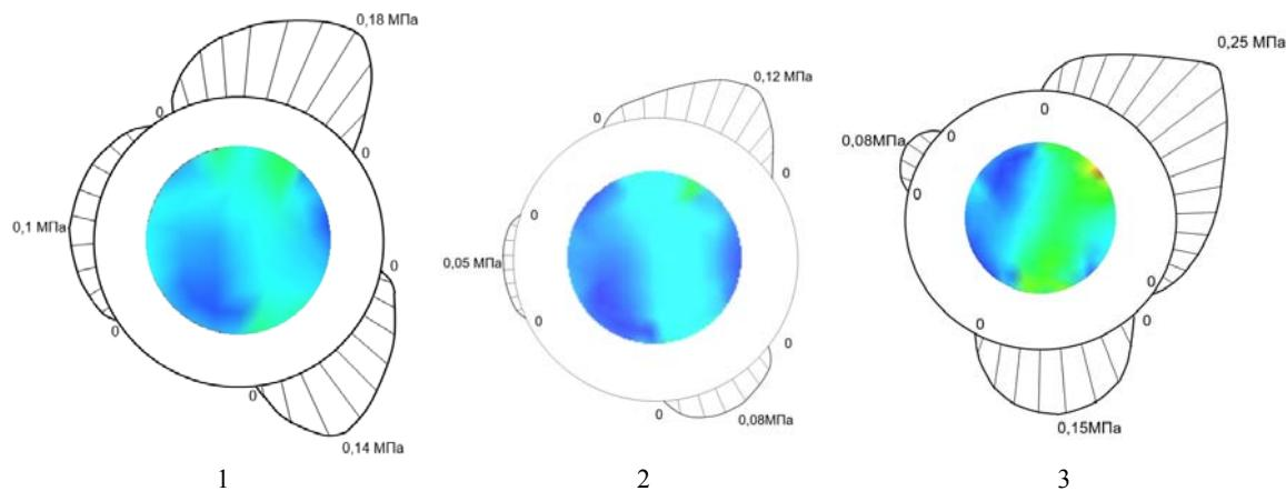
Рис. 3 – Епюра нормальних напруженій для розглядуемых положень елемента загрузки: 1 – перве расчетне положение, 2 – друге расчетне положение, 3 – третє расчетне положение
